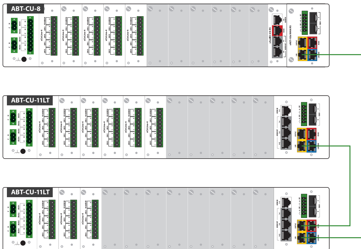
Rysunek 63. Przykładowe połączenie jednostek kontroli w topologii CHAIN
