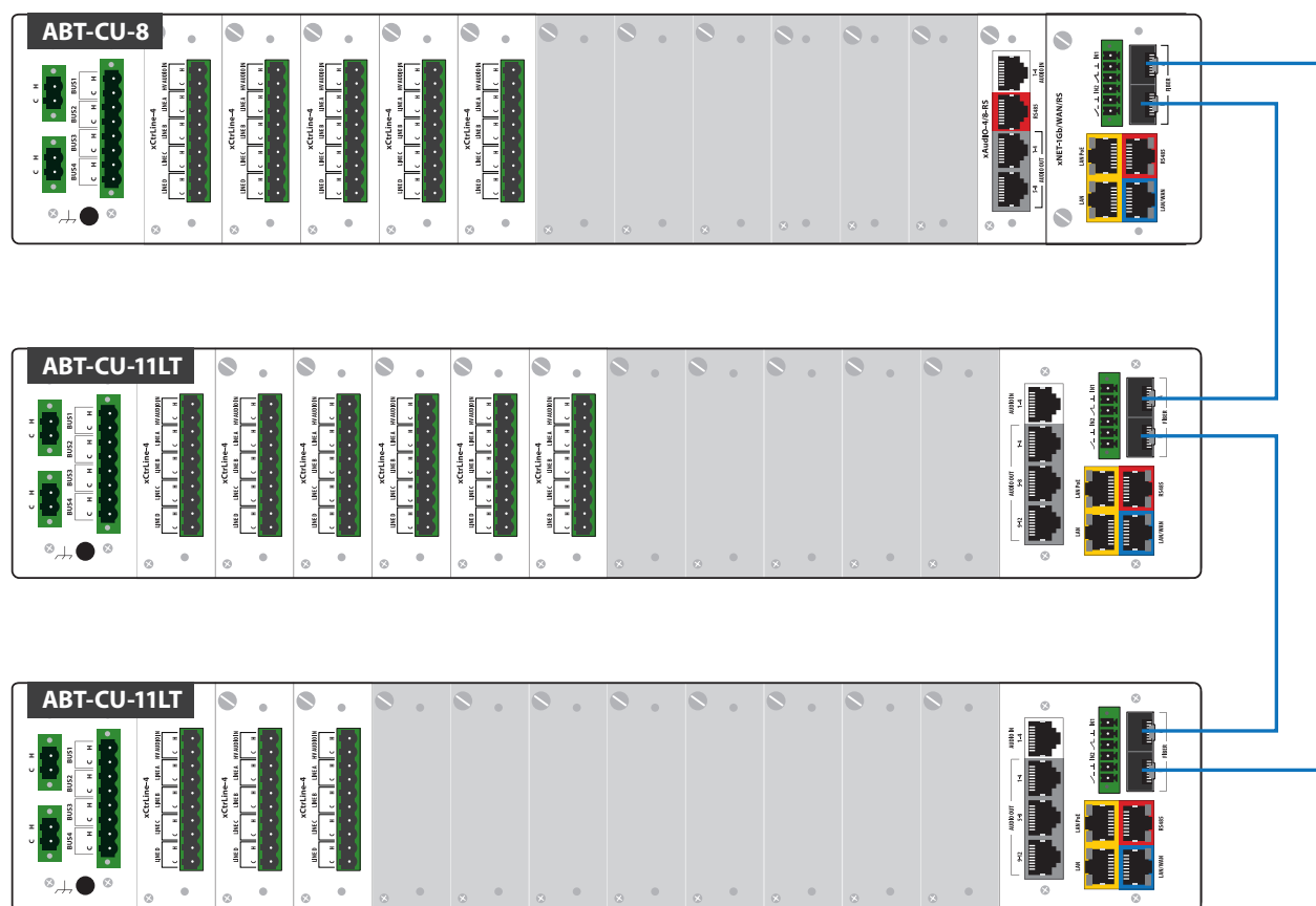
Rysunek 64. Połączenie jednostek kontroli w topologii RING (światłowód)
